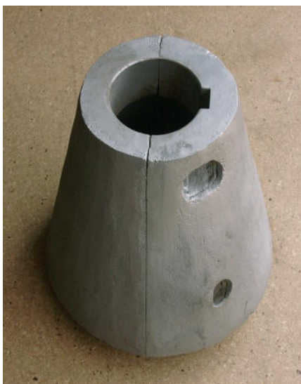
mit Keramikpaste HUP 1470 beschichteter Konus
