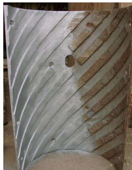
teilweise mit Keramikpaste HUP 1470 beschichtetes Verschleißblech
